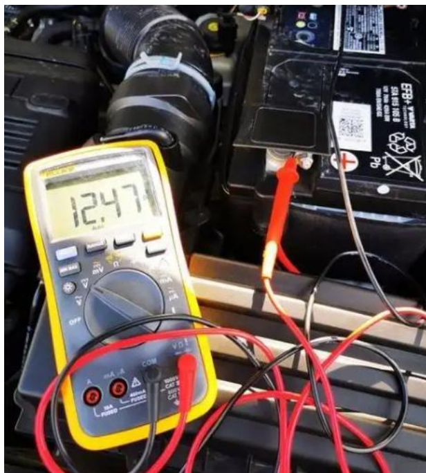
图 2.3 测量蓄电池电压
